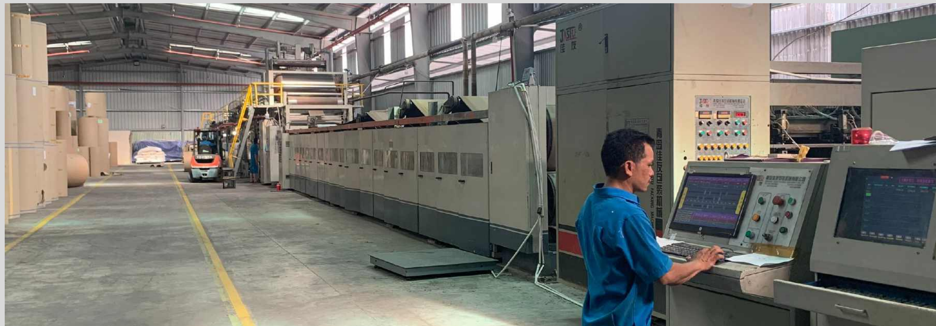
Dàn máy Sóng 2: tạo tấm giấy Carton 3, 5 lớp với các loại sóng B; C Corrugated cardboard production line 2, create B, C flute corrugated board
