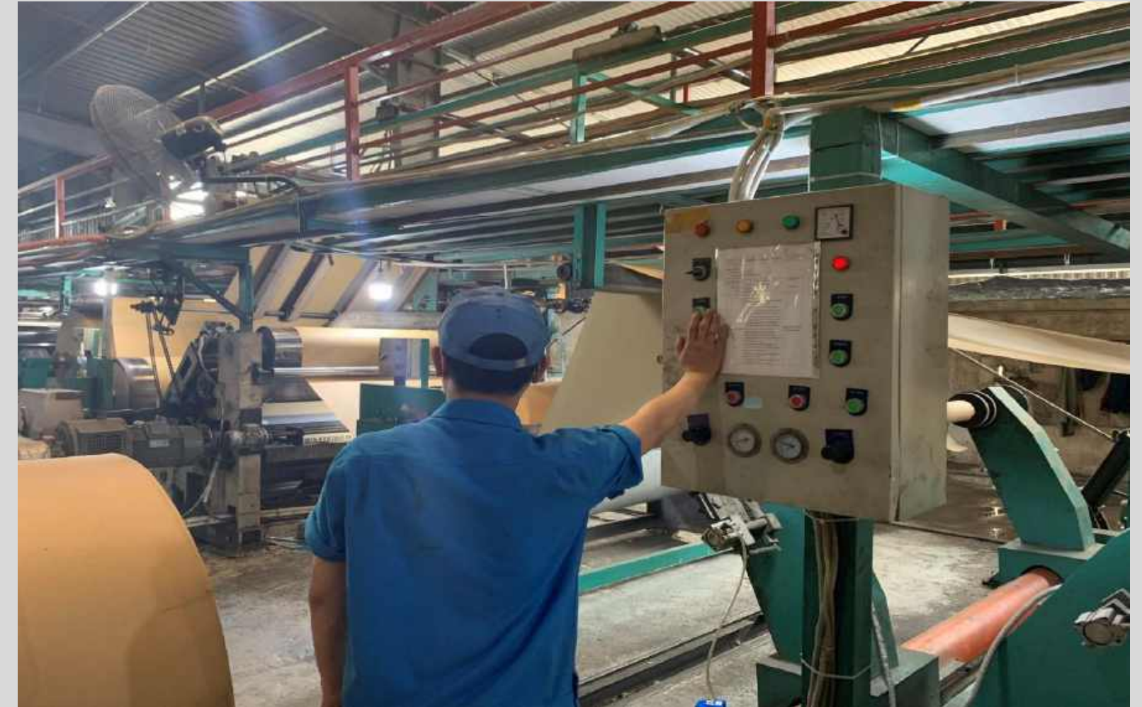
Dàn máy Sóng 1: tạo tấm giấy Carton 3, 5 lớp với các loại sóng B; C; E Corrugated cardboard production line 1, create B, C, E flute corrugated board
