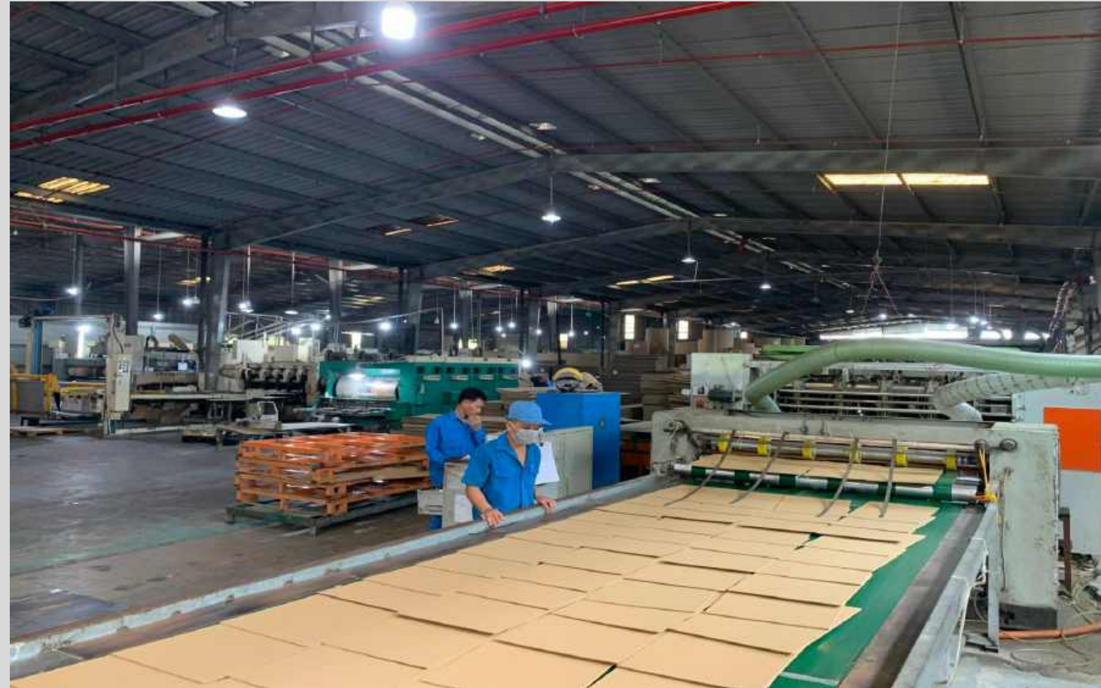
Dàn máy Sóng 1: tạo tấm giấy Carton 3, 5 lớp với các loại sóng B; C; E Corrugated cardboard production line 1, create B, C, E flute corrugated board
